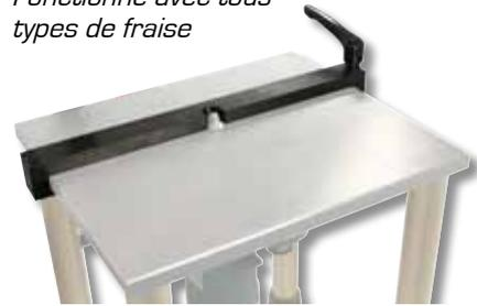
La Règle de guidage assure une meilleure sécurité et un chanfreinage plus rapide des petites pièces prismatiques.
